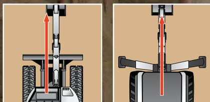
**Desvio do Operador** numa escavadeira, coloca o operador do lado da lança, para uma visão desobstruída do acessório. Num trator carregadeira retroescavadeira, você tem que se inclinar em torno da lança para ver o acessório.
