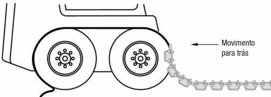
Com o auxílio de uma corrente ou corda, as esteiras podem facilmente "vestir" os pneus apenas movimentando-se a minicarregadeira lentamente para trás.
