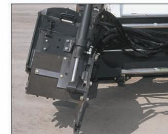
O controle hidráulico da inclinação e da movimentação lateral permite que a minicarregadeira se movimente pela rua enquanto fresa um meio-fio ou calçada.
