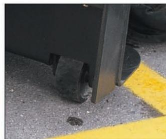
Rodas de aço montadas na parte traseira da fresadora ajudam no suporte da fresadora no início do corte e durante a fresagem.
