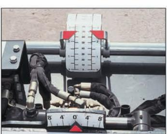
A marcação da profundidade de cada ski e da inclinação da fresadora é facilmente visualizado de dentro da cabine do operador.
