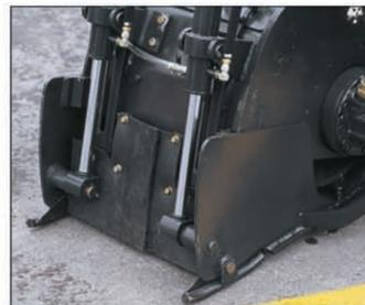
Cilindros duplos com ajustes independentes possibilitam o controle de profundidade para cada ski. \*\* Fresadoras de 15 polegadas utilizam apenas um ski.
