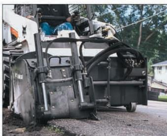
A fresadora permite que se trabalhe com inclinação. Desta maneira é possível manter o ângulo do corte mesmo quando a superfície não é nivelada.
