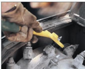
Uma tampa na parte superior da fresadora deixa uma abertura suficiente para substituir os bits de fresagem. Não há necessidade de levantar a fresadora ou retirar o tambor.
