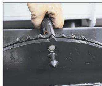
A caixa da fresadora inclina até  $\pm 15^\circ$  para fresagens com ângulo ou para emparelhar a superfícies. Uma marcação indica a inclinação a cada  $\pm 5^\circ$ .
