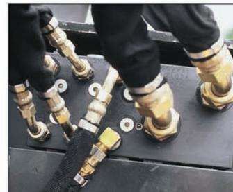
As fresadoras de alta-vazão utilizam uma válvula prioritária que desvia o óleo para as funções de aprofundamento sem causar qualquer perda de força no tambor; esta característica assegura a possibilidade de ajustes pelo operador durante a ação de fresagem.
