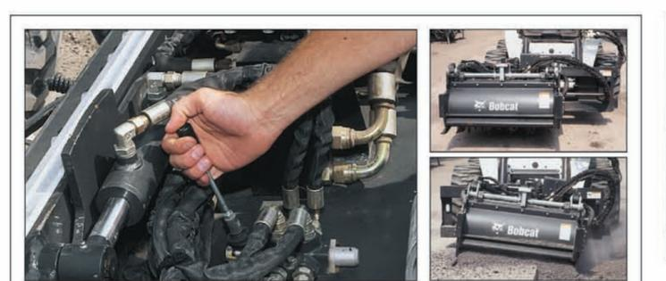
Use a válvula de divergência para escolher entre movimentação lateral hidráulica e inclinação hidráulica.
