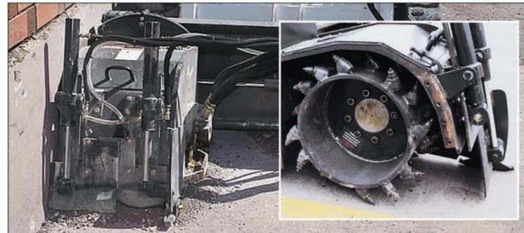
O ski e a lateral direita da fresadora são removíveis para permitir um corte mais rente a um meio-fio ou muro (tambores de 14, 16, 18 e 24 polegadas). Os bits de corte lateral reduzem o desgaste do tambor e melhoram a aderência do corte.
