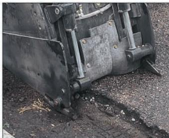
Os skis de desgaste da fresadora são de fácil reposição e garantem o controle da profundidade de fresagem. Existe também a possibilidade de utilização do opcional kit de rodas para substituir os skis.
