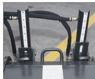
A profundidade dos skis pode ser visualizada de dentro da cabine do operador em uma marcação de 0 a 6 polegadas (0 a 15 centímetros).
