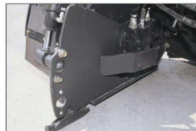
O ski único de duas posições possibilita que a fresadora seja usada para fresar meios-fios quando travada na posição superior. Quando utilizada com o ski travado na posição inferior, a fresadora funciona da maneira tradicional para moer asfalto ou concreto.
