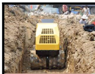
Como a árvore de came está com o suporte central, a máquina pode compactar as bordas completamente, sem nenhuma falha.
