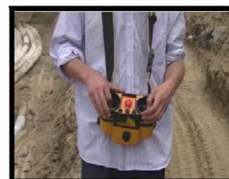
O controle remoto pode controlar os comandos de partida e parada do motor, avanço/recuo, esquerda/direita, alteração na vibração entre pouca e muita. Enquanto isso, também pode monitorar a temperatura do óleo, da água, etc.
