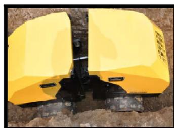
Com a estrutura da árvore de came, a máquina pode ser usada em valas pequenas.
