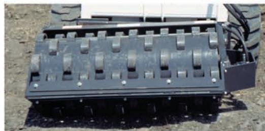
A inclinação do tambor mantém o rolo em contato com a superfície em terrenos desnivelados.
