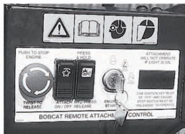
Disponibilidade de kit de controle remoto de acessórios (apenas para minicarregadeiras Bobcat). O kit permite que o operador ligue a máquina e opere a betoneira de fora da máquina. Isto elimina a necessidade de outra pessoa dentro da máquina para operar o acessório.
